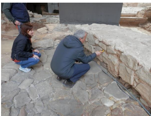
Primera imatge: moment de calibració de humitat amb bomba de carbur, imatge següent: lectura directa de humitat interior de mur mitjançant conductímetre electrònic.
