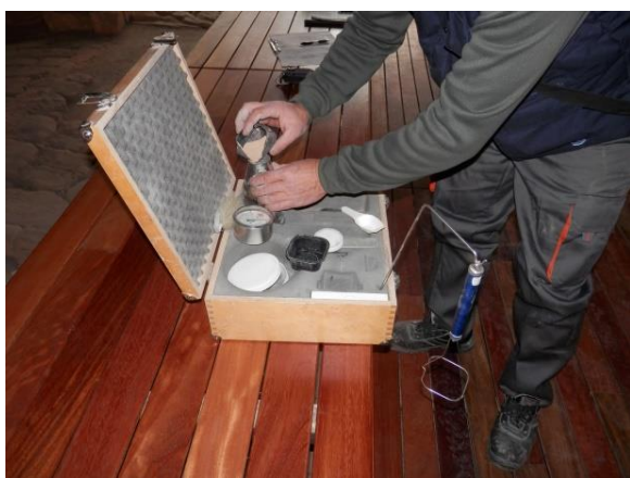
Primera imatge: moment de calibració de humitat amb bomba de carbur, imatge següent: lectura directa de humitat interior de mur mitjançant conductímetre electrònic.
